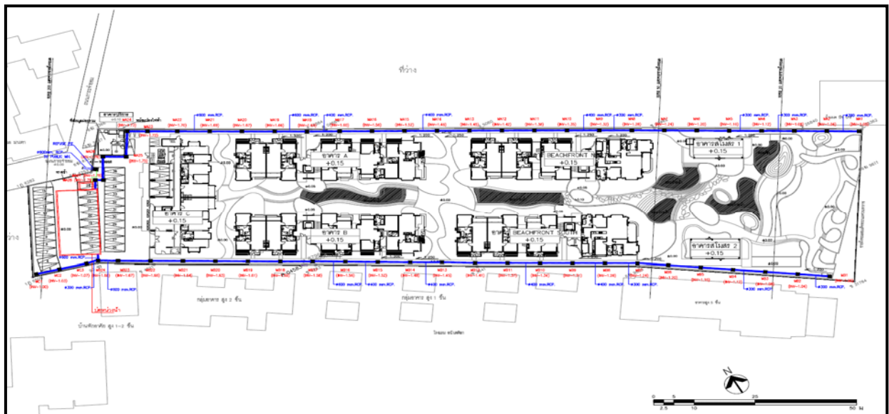
รูปที่ 1.9.3-2 ผังระบบระบายน้ำฝนในโครงการ
